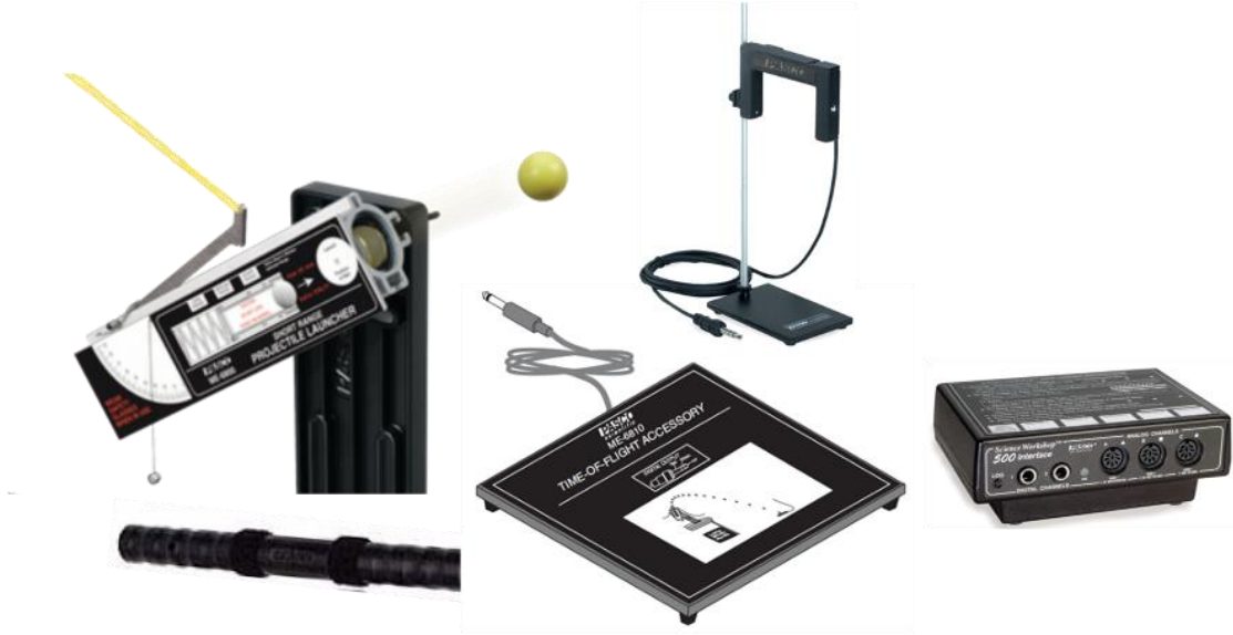
Şekil 5.4 Eğik atış düzeneği, plastik çubuk, uçuş süresi aksesuarı, ışık kapısı, ara yüz.
