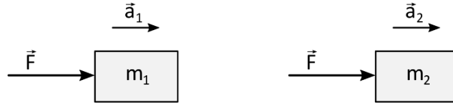
Şekil 7.1 Farklı kütleli iki cisme uygulanan sabit bir \vec{F} kuvvetinin cismin ivmesine etkisi.
