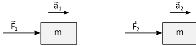
Şekil 7.2 Aynı kütleli iki cisme uygulanan farklı \vec{F} kuvvetlerinin cismin ivmesine etkisi.
