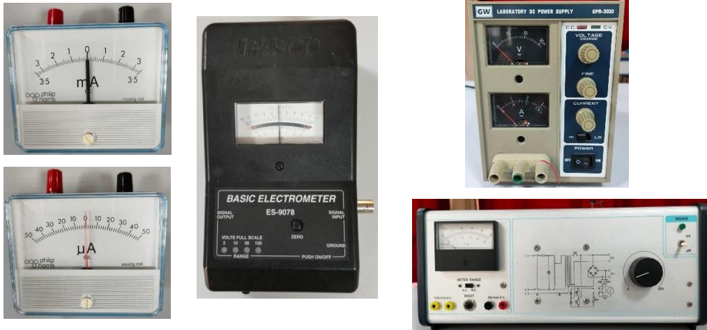
Şekil 1.1 Laboratuvarımızda kullanılan analog ölçü aletleri; miliampermetre, mikroampermetre, elektrometre ve güç kaynakları.
