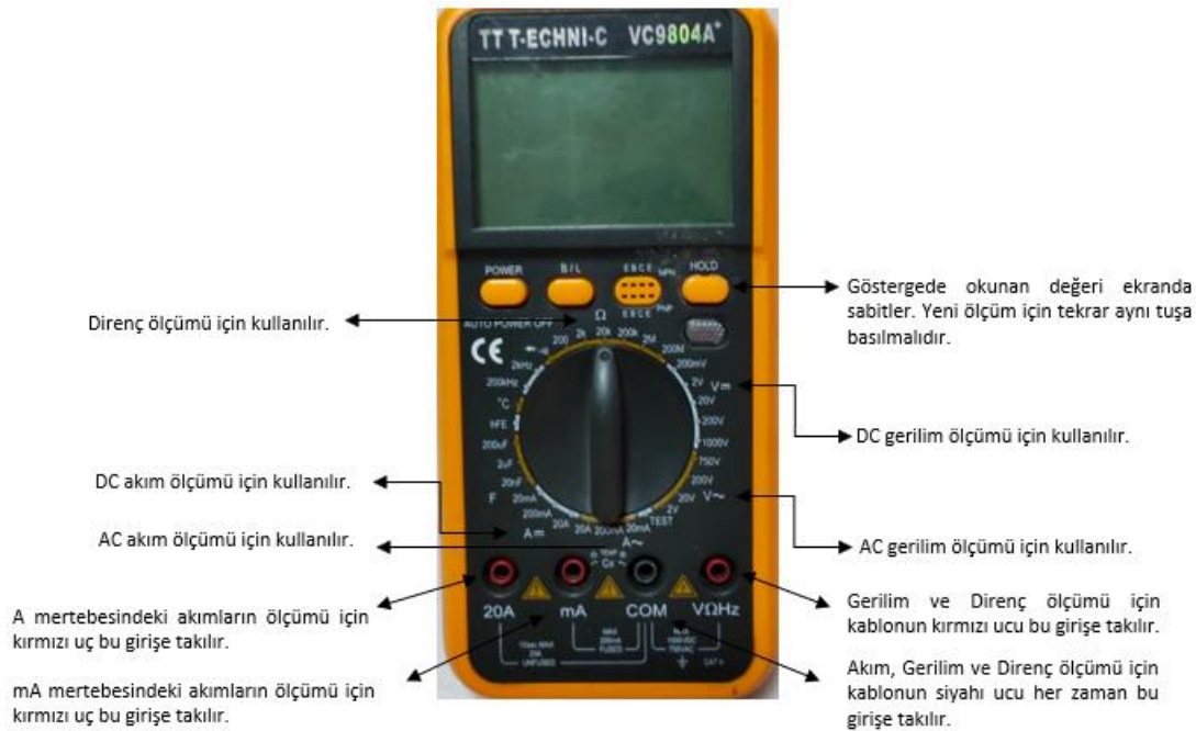
Şekil 1.3 Dijital multimetrenin kullanımı
