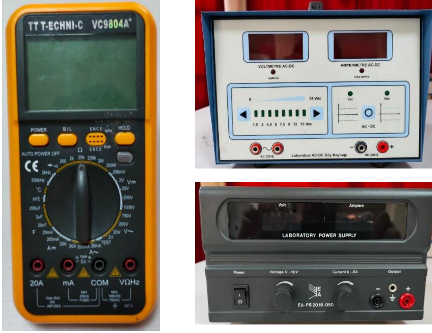
Şekil 1.2 Laboratuvarımızda kullanılan dijital ölçü aletleri; dijital multimetre ve güç kaynakları.
