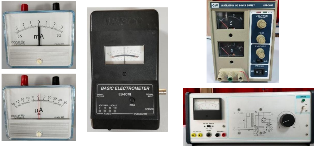
Şekil 1.1 Laboratuvarda kullanılan analog ölçü aletleri; miliampermetre, mikroampermetre, elektrometre ve güç kaynakları.
